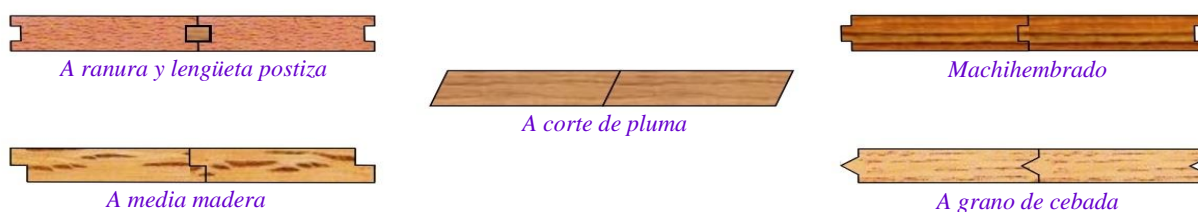
Fig. 7: Esquemas de diferentes modalidades tradicionales de ensamblados laterales de los pavimentos de madera.
