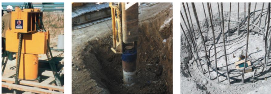
Figura 9: Ensayo de prueba de carga, ensayo dinámico de carga y control de integridad por impedancia
